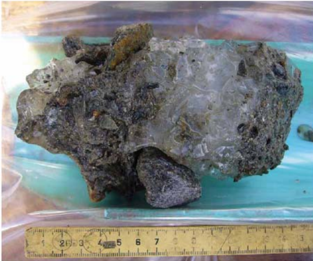
Campione di ghiaccio misto a detrito estratto da un rock glacier (da: PermaNET Synthesis Report; foto: David Tonidandel)
